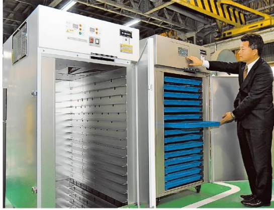
新型の電気乾燥機。左がホワイト塗装の標準型、右がステンレス製の全自動型
